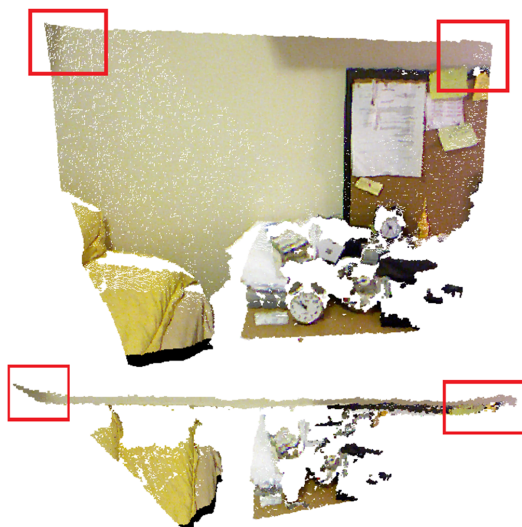
Figura 31: Erros na medição da nuvem de pontos vista de frente e cima. Os quadrados vermelhos mostram pontos com alta imprecisão da nuvem de pontos em relação ao modelo real.
